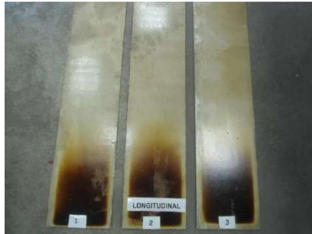
Foto nº3: Aspecto de la zona afectada por la radiación de las 3 muestras ensayadas
